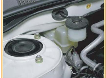
El uso continuo de poco líquido de frenos o de líquido sucio y la falta de reemplazo durante un período prolongado pueden causar la pérdida de efectividad en el frenado y provocar accidentes.
