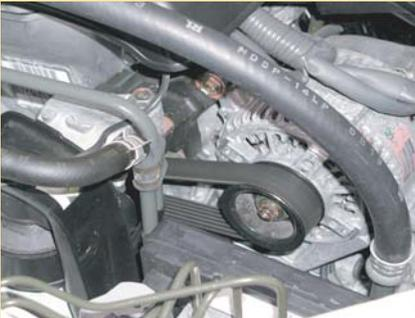
El uso de una correa floja o gastada puede producir su rotura, impidiendo la recarga de la batería o causando el sobrecalentamiento del motor.
