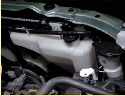
El uso continuo de poco refrigerante o de refrigerante sucio y la falta de reemplazo durante un período prolongado pueden producir sobrecalentamiento o corrosión en el radiador.
