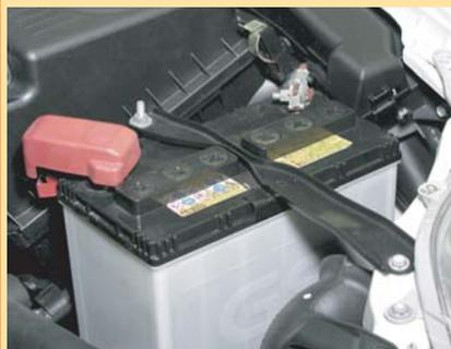
El uso de una batería con bajo nivel de fluido puede hacer que no funcione, se sobrecaliente, o incluso, explote.
