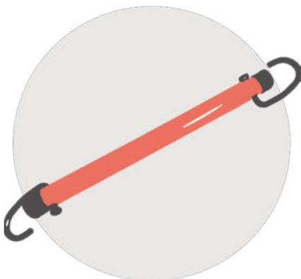
Dispositivo telescópico homologado, que sustituye cuerdas, cables y otros flexibles, que se encuentran prohibidos por ser inseguros y no válidos para remolque de vehículos.
